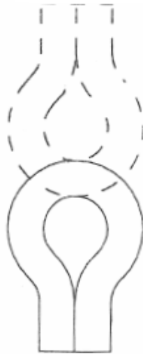
شکل ۱۰۵- موقعیت‌های خمش لوله خرطومی بعد از بیرون آوردن از اتاقک فریز
